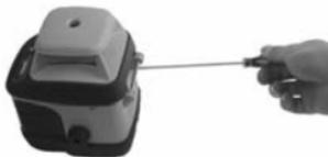
Ajuste el tornillo de calibración fina
