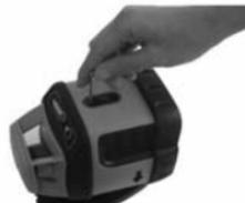
Calibre la burbuja utilizando una llave hexagonal de 2.5 mm
