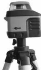
Ajuste al trípode utilizando la rosca 5/8" que se encuentra en la base del instrumento
